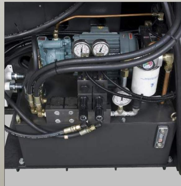
■ 高效能的油壓模組，提供工作台的煞車系統，以保證工作台重負荷的鎖固力。
